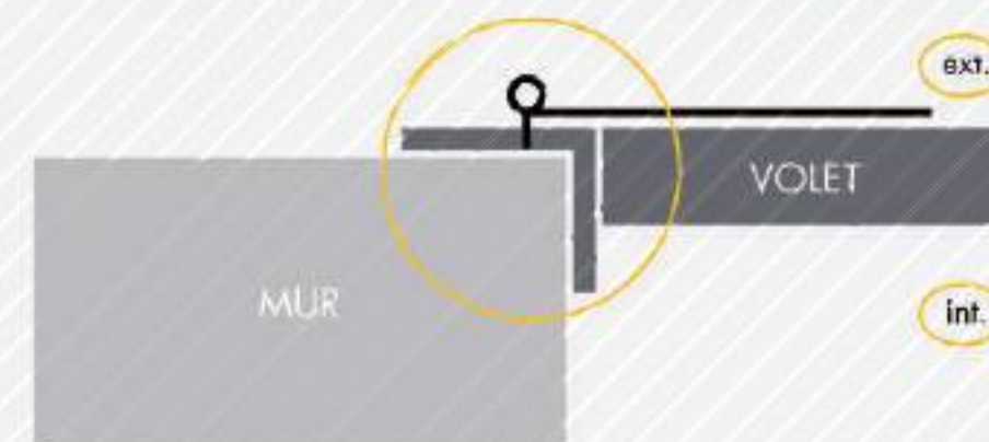
Pose en FEUILLURE Le volet se ferme dans une encoche en haut, à gauche, à droite
