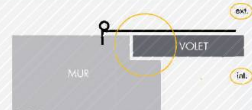
Pose en FEUILLURE Le volet se ferme dans une encoche en haut, à gauche, à droite
